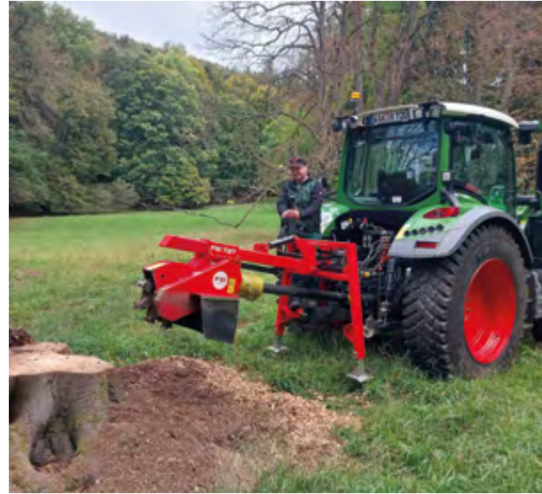
Fräsen eines Baumstumpfs für eine Nachpflanzung im Schlosspark Altenstein
