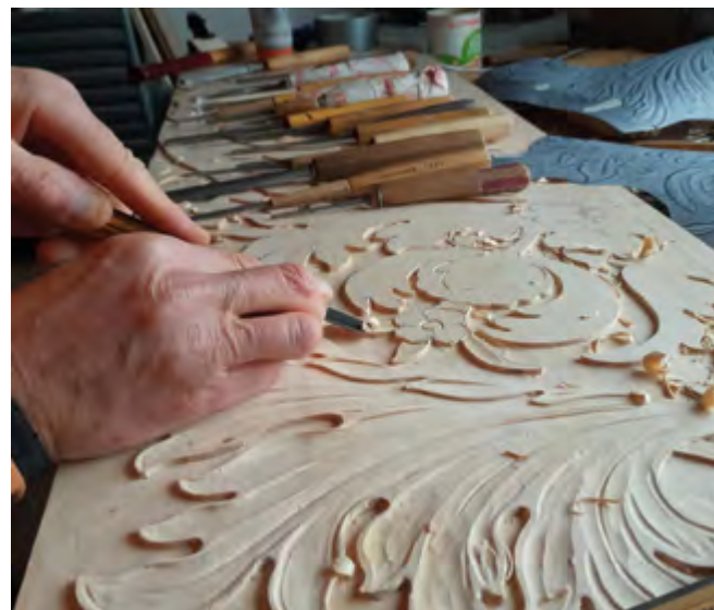
Herstellung der Reliefplatten in der Holzwerkstatt
